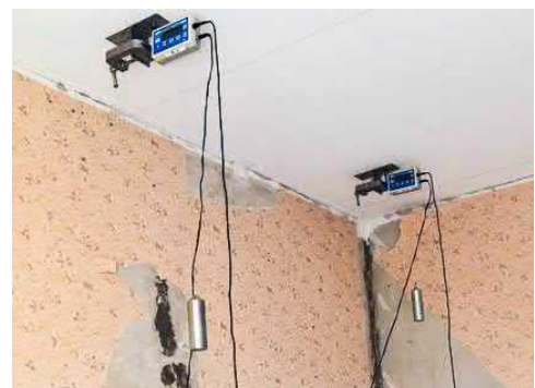
◀ Индикаторы перемещений. Графики деформаций
