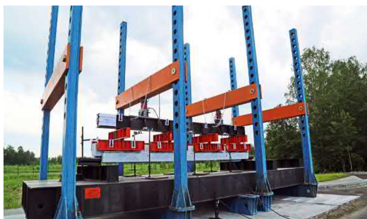
▼ Силовой стенд для испытания строительных конструкций
