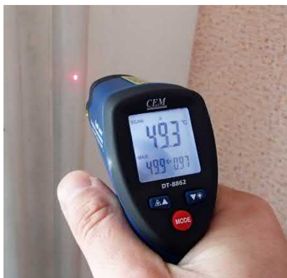
▲ Измерение температуры пирометром
